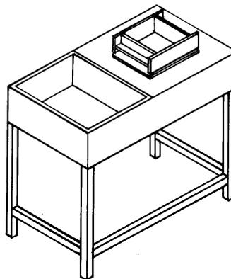
El moldeado sobre la mesa permite una posición de trabajo confortable. El adobe es transportado dentro de su molde hasta el aire de secado.
