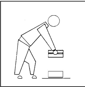
El moldeo se realiza despues que la mezcla tierra/agua haya reposado minimo una noche.
