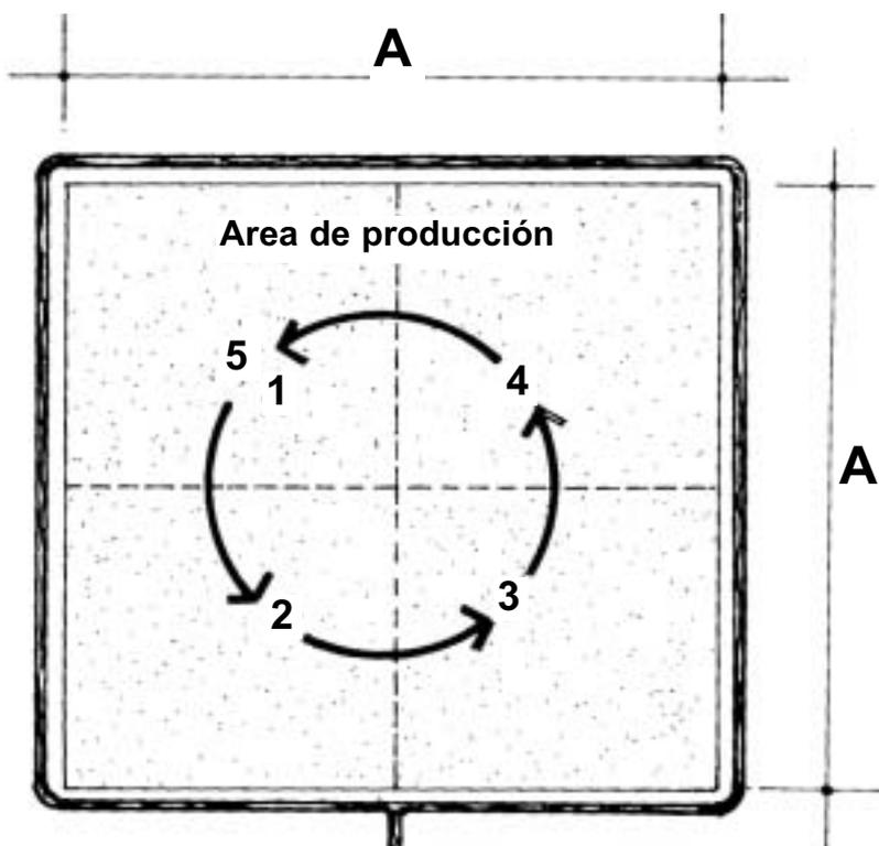
El área de producción se determina en función del rendimiento diario, las dimensiones del adobe (espesor) y su tiempo de secado.
