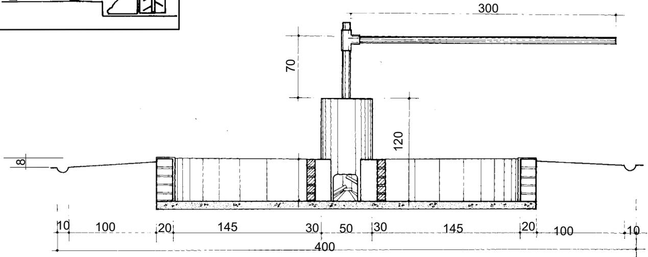
El recipiente del mezclador permite reposar 4 m<sup>3</sup> de tierra dentro del agua durante 24 horas. Luego para mezclarla se hace pasar por el tubo central del mezclador.
