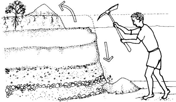
El material tierra proviene de la erosión mecánica y química de la roca-madre. Esta roca se desagrega en partículas minerales de dimensiones variables desde los guijarros hasta los polvos arcillosos. En la capa superficial estas partículas están mezcladas a las materias orgánicas que provienen de la descomposición del mundo viviente. Esta tierra "orgánica" está reservada a la agricultura. Las otras capas son utilizadas para la construcción.
